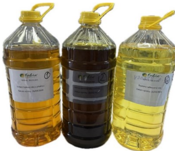
Obrázek 1 Vzorky řepkových olejů, lisovaný za studena (vlevo), lisovaný za tepla (uprostřed) a rafinovaný (vpravo)
